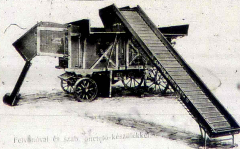
Clayton & Shuttleworth 10 lóerős benzínlokomobilja a 42 FDD cséplőgéppel.
